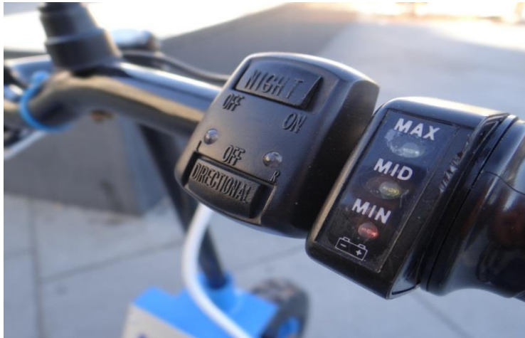
Slika 14: nadzorna plošča za stanje baterije in luči.
